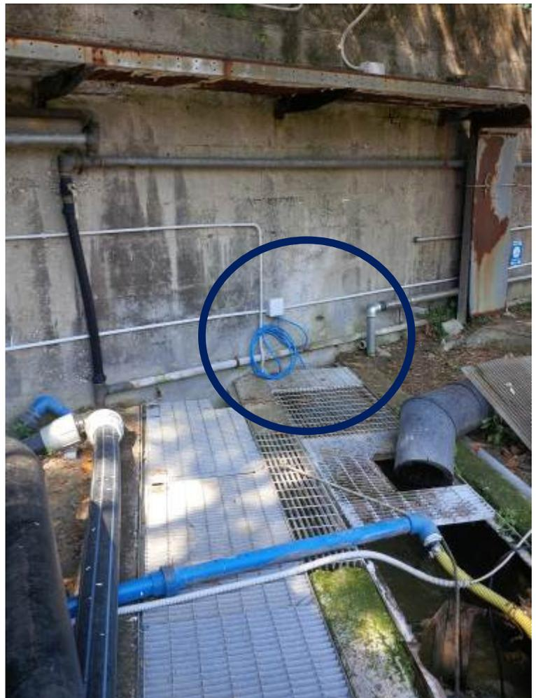
Figura 16 – Foto del Pluviometro installato all’impianto di Massa Centro
